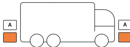
Bei Zügen muss die hintere Tafel an der Rückseite des Anhängers angebracht sein.
